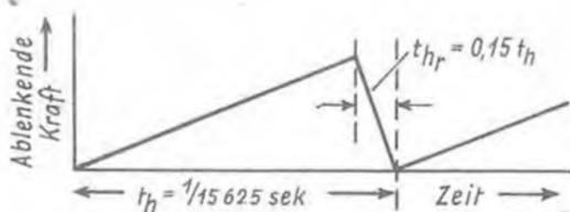
Abb. 11. Verlauf der auf einen Bildstrahl wirkenden Ablenkkräfte bei Abtastung einer Bildzeile für  $n = 625$  Zeilen und  $N = 25$  Bildwechsel je Sekunde. Die ablenkende Kraft ist proportional dem Weg der Strahlspitze angenommen.
