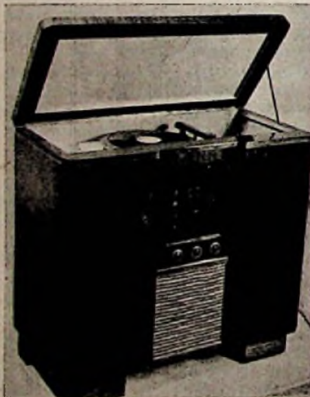
Der 9-Kreis-6-Röhrensuper der Firma Alfa-Radio mit einer Flüssigkeitssäule als Abstimmungsanzeige. Der drehbare Sockel vom Vorjahr wurde beibehalten
