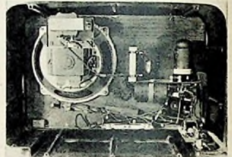
In der Mitte des Bildes ist deutlich die Permeabilitätsabstimmung erkennbar. Sämtliche Einzelteile sind auf der Schallwand montiert
