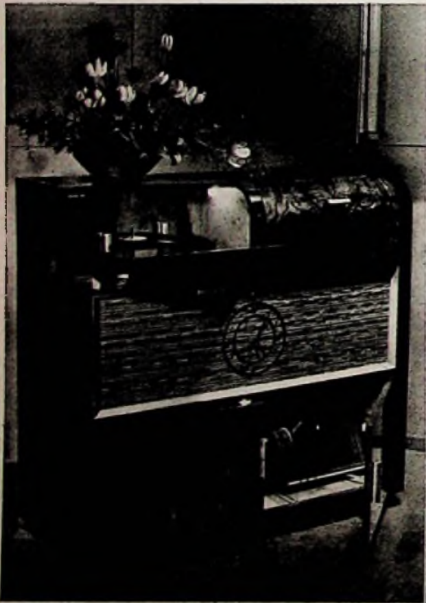
Eine geschmackvolle Musiktube mit einem 6-Röhren-6-Kreis-Spitzen-Super mit dreifach gespreiztem KW-Teil, eingebautem Einfach- oder Zehnplattenwechsler der Firma Juscha, Eisenach
