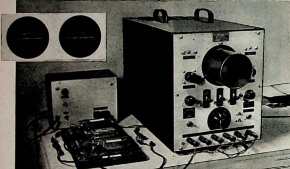
Kurzzeitmeßgerät der RFT Arnstadt zur Sichtbarmachung von Schaltvorgängen und zur Messung der Schaltzeiten. Im Schirm der Braunschen Röhre wird elektrisch eine Zeitmarke erzeugt, die einen Vergleich und ein unmittelbares Ablesen des zeitlichen Verlaufes der Schaltvorgänge gestattet. Das Gerät hat zwei Meßbereiche, und zwar für 40 µsec und 4 msec. Das zu untersuchende Relais wird durch eine besondere Vorrichtung in einem festgelegten Rhythmus an- und abgeschaltet. Die beiden Aufnahmen zeigen links den Einstell- und rechts den Abstellvorgang
