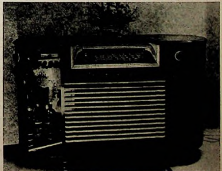
Eine hübsche Konstruktionsidee war an dem Rema 664 W zu sehen. Die Skalenlampe und die Skala selbst können durch einfaches Verschieben der Holzklätze herausgenommen werden
