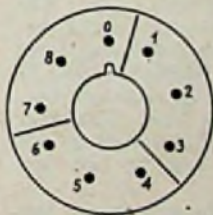
④ Sockelschaltung des Zerschackers MZ 6001 (von unten gesehen)
