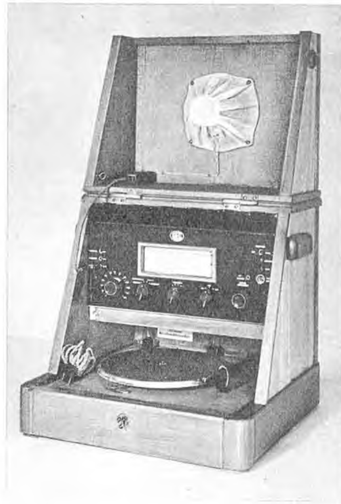
Abb. 1. Lorenz-Schulfunkgerät im betriebsfertigen Zustand Abb. 2 (links). Das zugeklappte und abgeschlossene Schulfunkgerät ist absolut „schülersicher“
