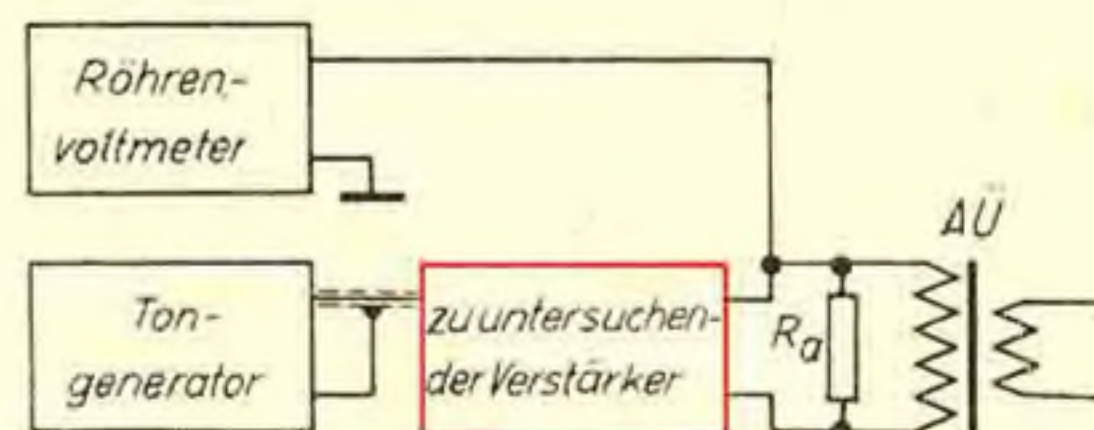
Abb. 41. Frequenzgangaufnahme eines Verstärkers
