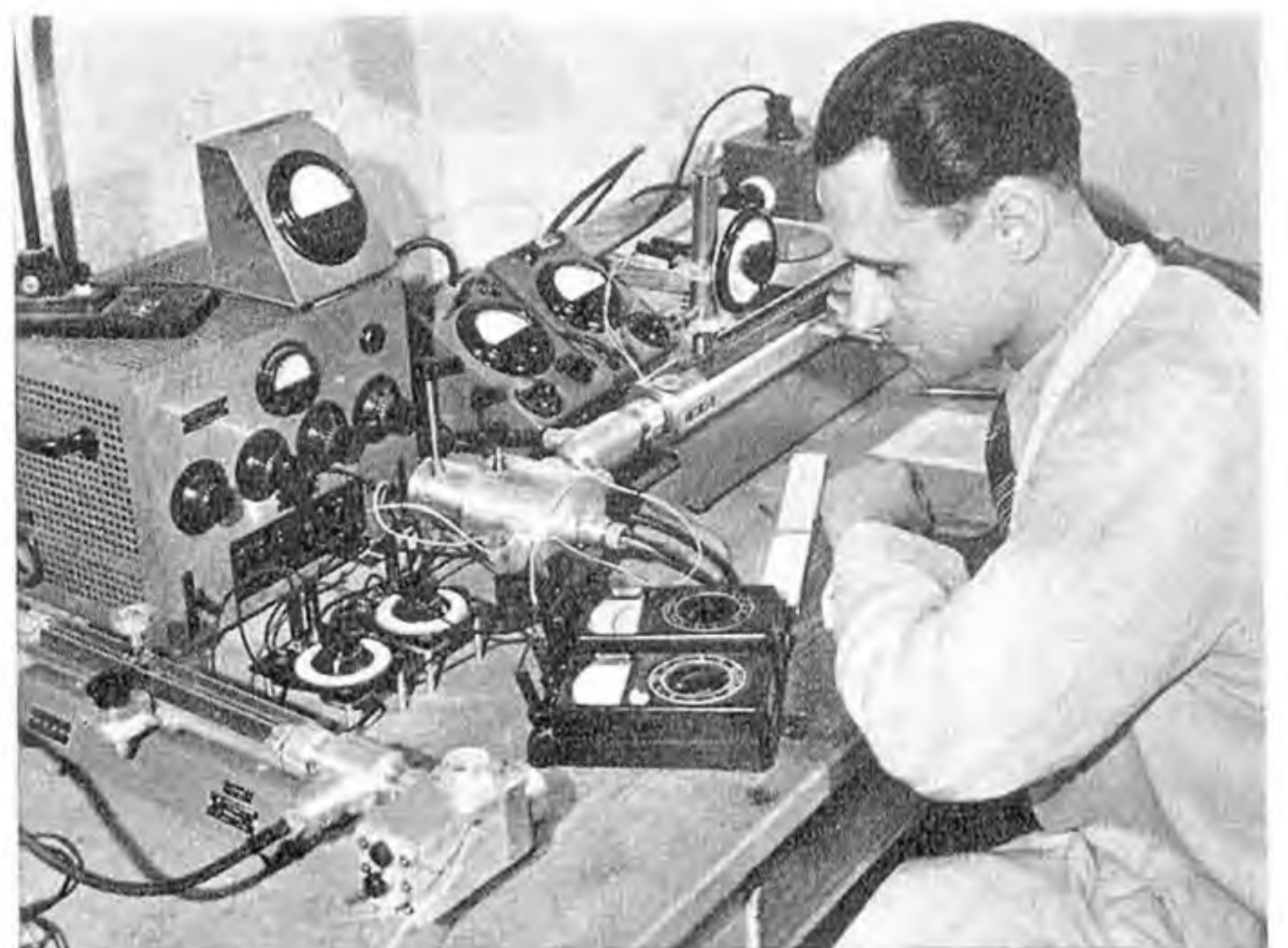
Eine Dezimeter-Meßleitung mit abstimmbarer Präzisions-Tauchsonde
