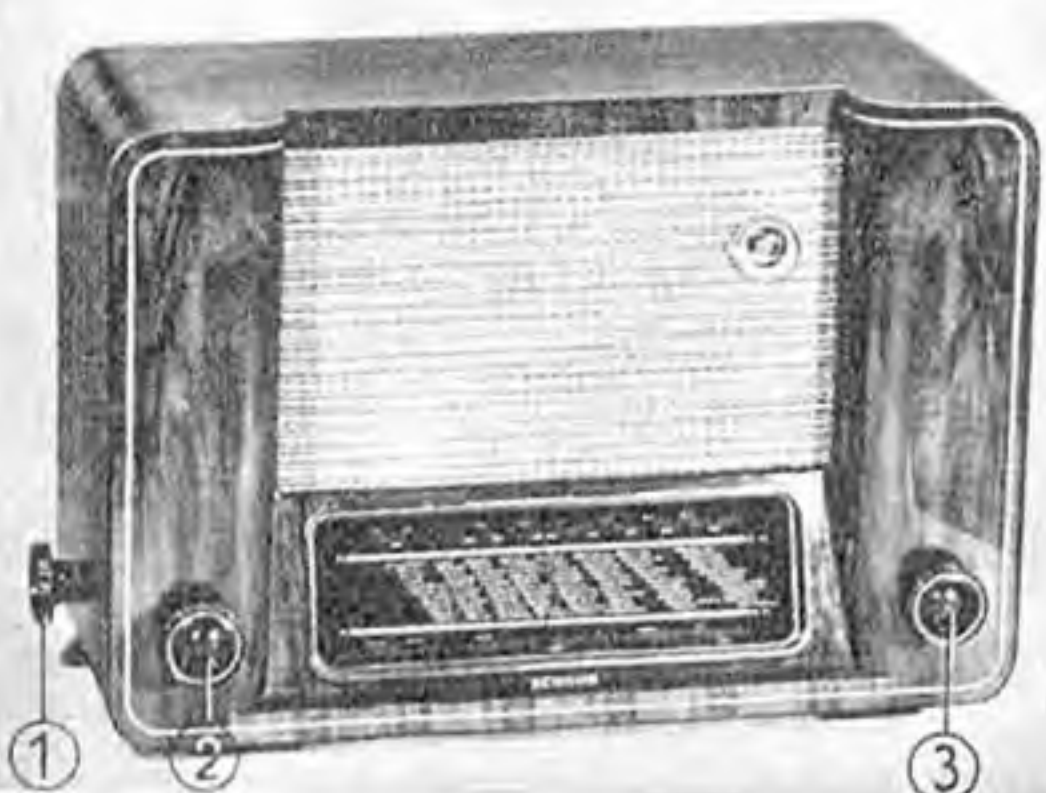
① Tonblende, ② Lautstärkeregel mit Netzschalter, ③ Abstimmung
