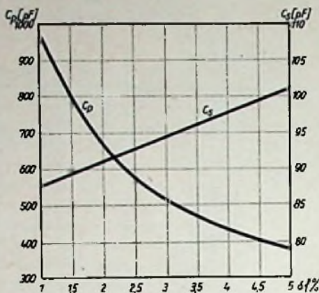
Abb. 2. Dimensionierung der Bandkondensatoren
