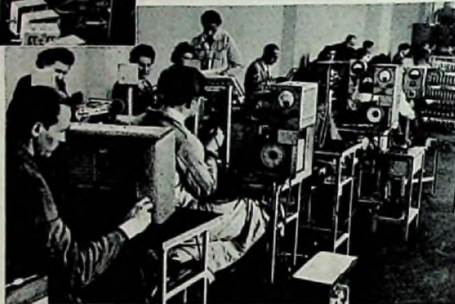
Um jeden Ausfall in der Bandfabrikation zu vermeiden, ist es notwendig, die Einzelteile genauestens zu prüfen. Unser Bild zeigt das Vorprüfen der Drehkondensatoren bei der Philips-Fertigung
