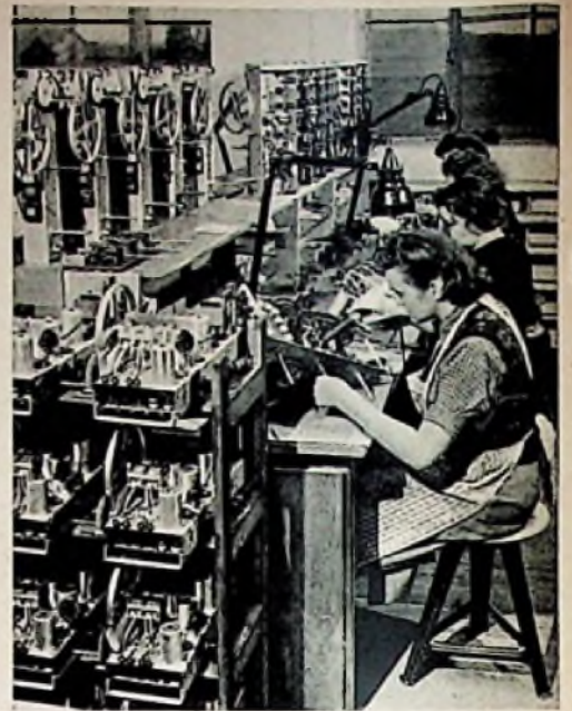
Chassis reiht sich an Chassis. Die letzten Lötungen verbinden das am Schluß der Bandmontage eingebaute Schalteraggregat mit dem Chassis
