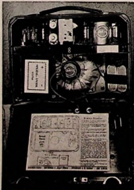
Die „Luxus“-Ausführung des Akkord-Koffersupers. Im Foto ist die rechte „Schiebetür“ geschlossen. Das Innere des Koffersupers ist leicht zugänglich
