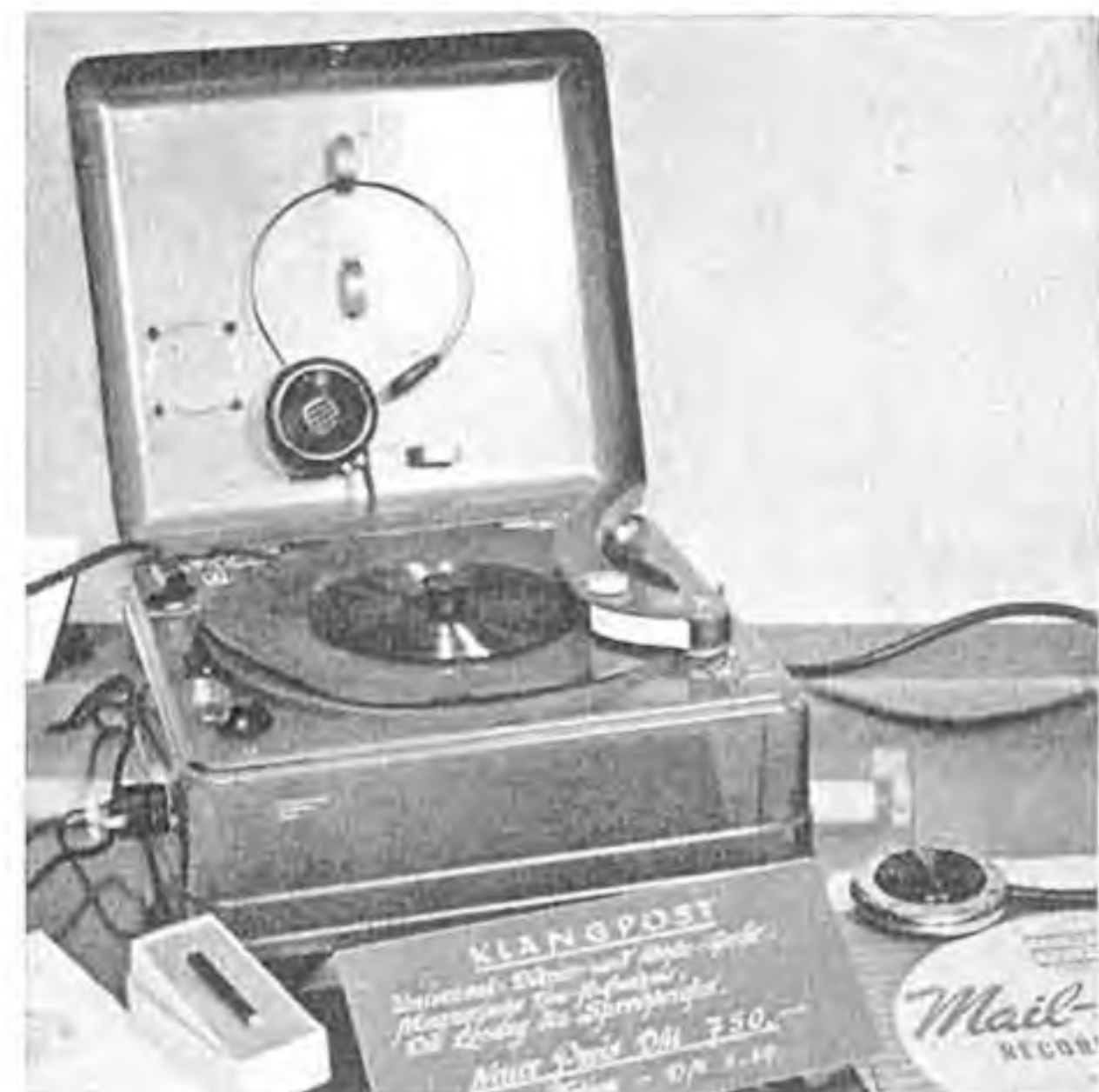
Rechts: Klangpost-Diktiergerät für Aufnahme und Wiedergabe. Als Tonträger dienen mit einer hauchdünnen Metallschicht überzogene Papier- und Plastik-Tonfolien
