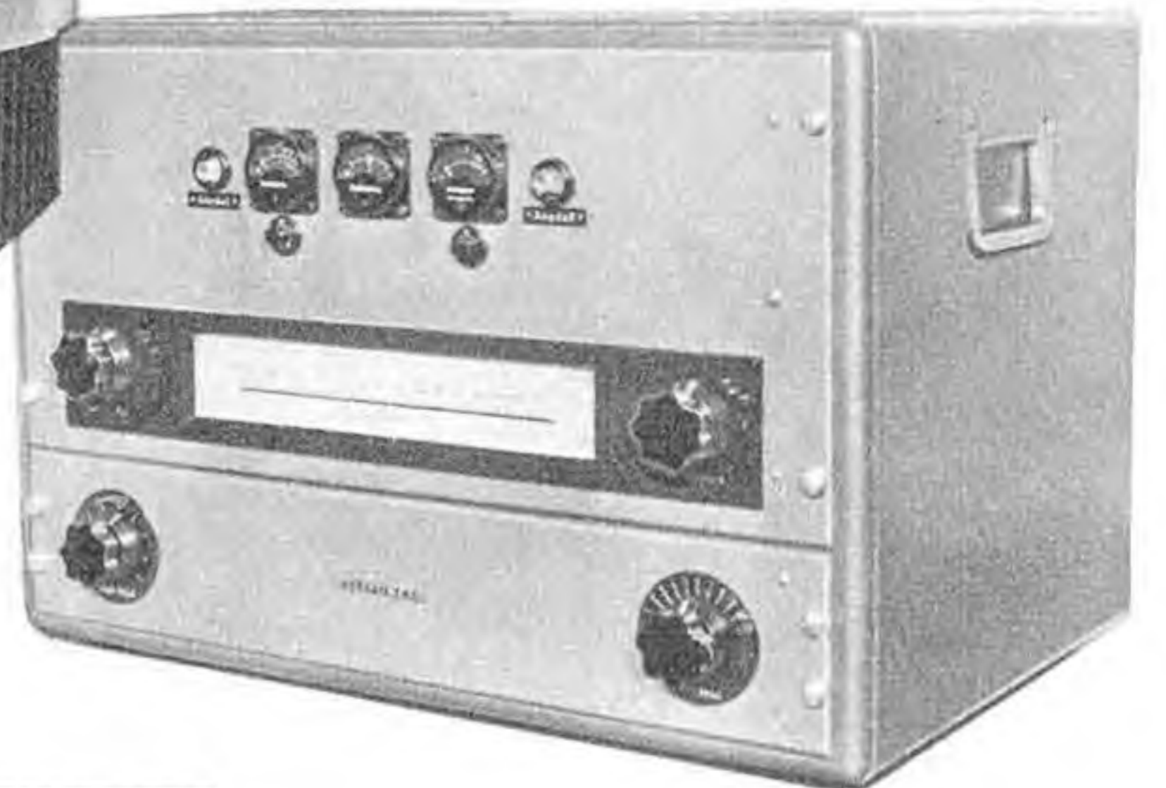
Rechts: Telefunken-19-Röhren-UKW-Ball- und Monitor-Empfänger EB/VK/3/1 für 87 ... 100 MHz
