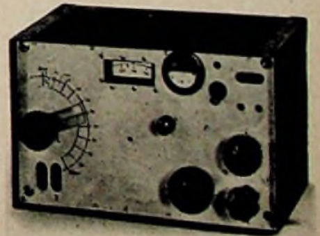
Abb. 4. Vorderansicht des Gerätes. Die beiden Knöpfe rechts außen dienen zur Bedienung des Telegrafieüberlagerers
