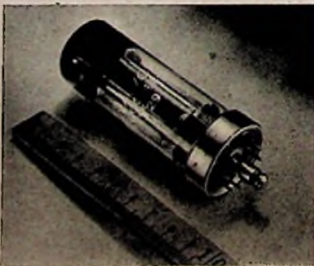
Trotz kleiner Ausmaße kann die UKW-Doppeltetrode QQC 04/15 9...20 W Nutzleistung abgeben
