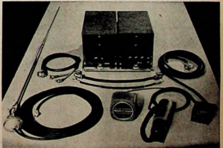
Die Philips-Mobiltelefon-Anlage. Das Bedienungsgerät kann in das Armaturenbrett eingebaut werden
