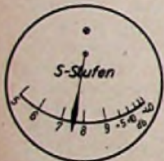
Abb. 1. Schaltbild des UKW-Empfängers „e“, in dem die für den Amateurbetrieb zweckmäßigen Änderungen rot eingezeichnet sind. Abb. 2 (links nebenstehend). Die vorgeschlagenen Skaleneinteilung für das S-Meter
