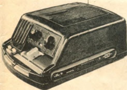
„Mentor“-Diktiergerät. Vorn sieht man die Rillensmanschette, den Aufspreekopf mit Rillenanzeiger, Start/Stop- und Repetierschalter, links Lautsprecheröffnung und Betriebsartenschalter, oben Lautstärkeregl. Aufspreekzeit etwa 20 Minuten
