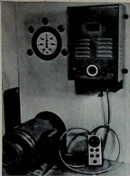
Elektronischer Motorregler „Tronomat“ von Pintsch-Electro. Oben: Steuergerät; unten: Motor und Bedienungseinrichtung (Ausführung für Demonstrationszwecke)
