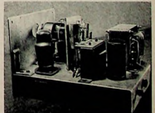
Abb. 2. Um kurze Leitungen zu erhalten, wurden die drei Röhren des HF- und NF-Vergleichsgerätes unmittelbar hinter der Frontplatte angeordnet
