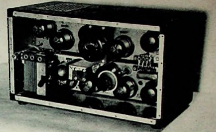
In der Umhängetasche befinden sich die Batterien und der Antennenkreis. Die Stabantenne ist an der Tragetasche angebracht. Die Verbindung mit dem in einem handlichen Kästchen, das oberhalb des Mikrofons anhält, untergebrachten Sender erfolgt über ein Koaxkabel. Im Hintergrund der Empfänger. Rechts oben: Ansicht des Empfängers, Abdeckplatte abgenommen
