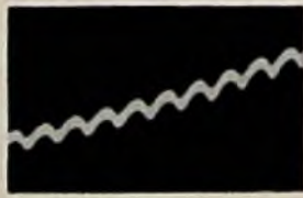
Abb. 2a. Vergrößerter Ausschnitt aus einem Oszillogramm des Lichtstromes einer Leuchtstofflampe mit überlagerter 22-kHz-Schwingung
