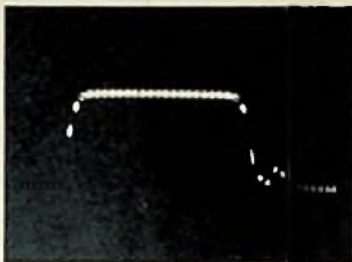
Abb. 6. Öffnungszeitverlauf eines Kamera-Zentralverschlusses (Compur) mit Zeitmarke durch Hellsteuermodulation f_m = 1000 Hz
