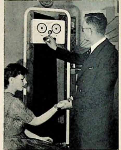
Herzfrequenz- und Pulsdruckmesser „Celocard“ der C. Lorenz A. G. Das Bild zeigt auch deutlich die Pulsabnahmevorrichtung am Arm des Patienten
