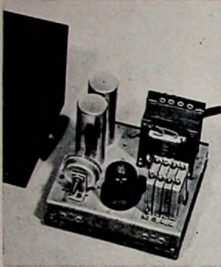
Abb. 7. Der Fotozellen-Vorverstärker befindet sich auf einem getrennten Chassis, das in ein allseitig geschlossenes Eisenblechgehäuse eingebaut ist
