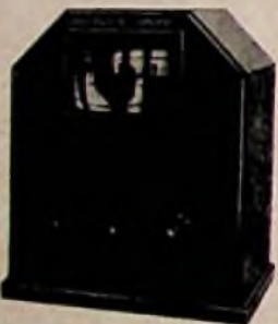
90-Zeilen-Empfänger, 25 Bildwechsel/sec, 10 800 Bildpunkte, rotierende Blende, Doppelspiralochscheibe, Natriumdampfampe, Bildgröße 9x12 cm
