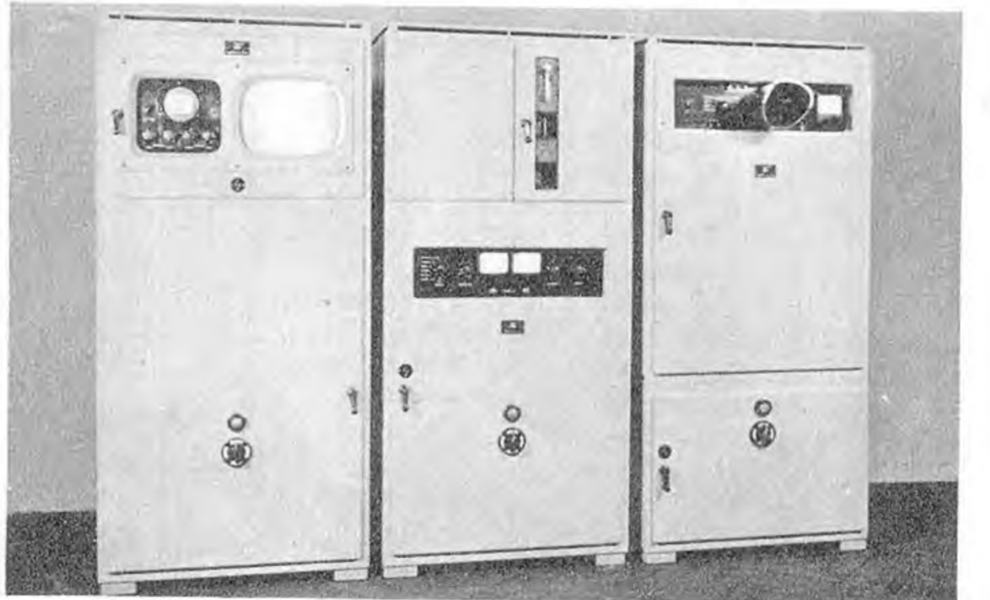
Anlage zur Übertragung von Diapositiven. In der Mitte Dia-Abtaster, links Kontrollempfänger mit Hilfseinrichtung, rechts Impulszentrale für die Synchronisierzeichen. Unten Aufnahme eines vom Diapositiv-Abtaster gelieferten und vom Kontrollempfänger gezeichneten Fernsehbildes
