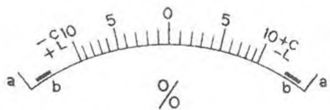
Abb. 2. Skalenbeispiel des Toleranzanzeigers, a) mechanische Anschläge, b) Endausschlag
