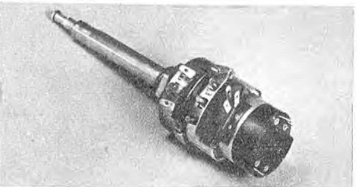
Abb. 7. Doppelregler mit Dreh- und Druckschalter
