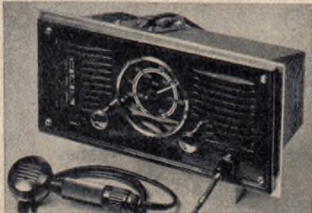
Omnibusanlage von Wandel & Goltermann, Ausführung 1951 (Typ „Gamma“ FW 51) mit Empfänger, Kontrolllautsprecher und Drucktastenschalter. Der Verstärker ist ebenfalls direkt eingebaut, Stromversorgung getrennt, Lautsprecher nach Wahl
