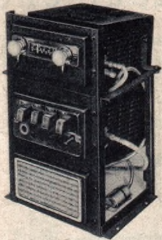
Autobusanlage von Blaupunkt, Modell A 710 B; oben Empfangsteil, Mitte Verstärker mit Umschaltfeld, unten Kontroll-lautsprecher des Gerätes
