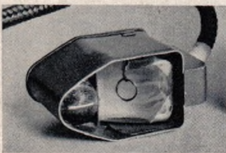
Links: Gleichlichtverstärker „Visolor VK 1“ der C. Lorenz AG, angebracht an einem Schreibinstrument. Oben: der Tastkopf des Visolor VK 1-Gleichlichtverstärkers
