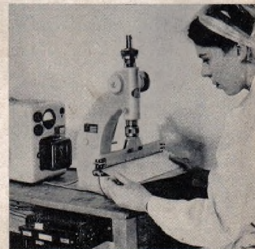
Lorenz-Wärme-Impuls Schweißplatz, links vor der Schweißpresse das Netzgerät, darunter Regelwiderstand Werkfoto
