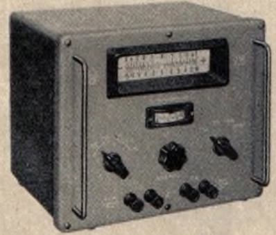
Tonhöhen-schwankungsmesser Typ J 60 der Firma W. Franz K. G.
