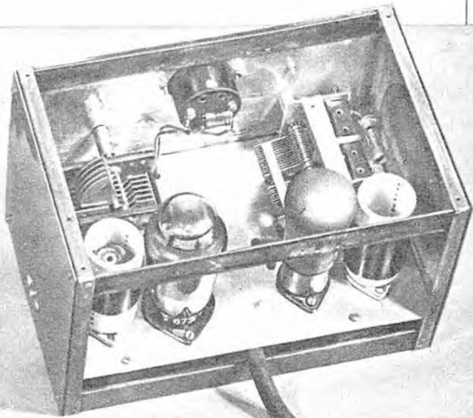
Abb. 2. Ein einfaches Collinsfilter läßt sich mit normalen Empfänger-Zweifachdrehkos aufbauen. C = je 2 \times 500 pF. L = etwa 10... 15 Wdg. 1,0 Cu blank 50 mm \varnothing . Sk = Glühlämpchen etwa 6,3 V/0,2 A
