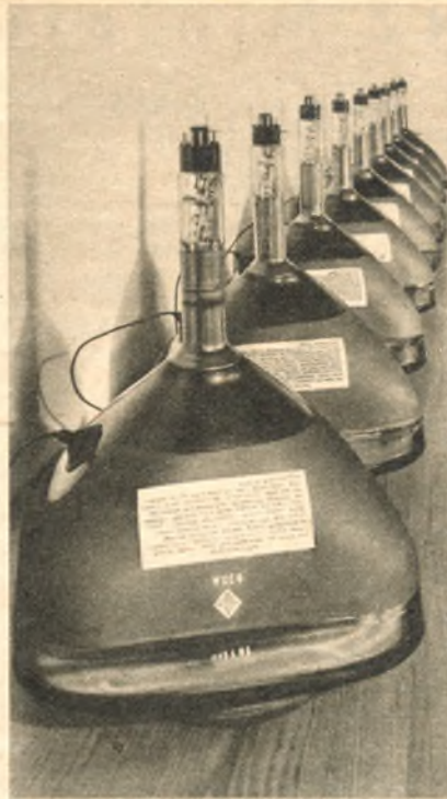
Abb. 5. Links Telefunken-Rechteckbildröhren B 35 A. Oben Maße, Bildfenster und Sockel der B 35 A
