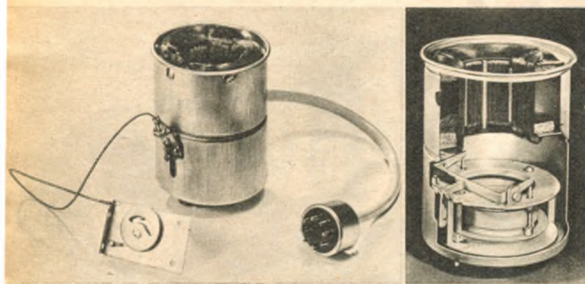
Abb. 1. Philips-Ablenk- und Fokussiereinheit für MW 36-22, Typ AT 1000-01; rechts Anschlußsockel für die Ablenspulen, links Bowdenzugsteuerung der Fokussierung. Rechtes Foto: Schnitt; unten Regelung des magnetischen Nebenschlusses des Fokussiermagneten
