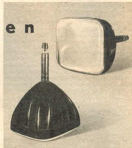
Abb. 2. Erste deutsche Rechteckröhre, bestimmt für den Einheitsfernsehempfänger E 1 (1939)
