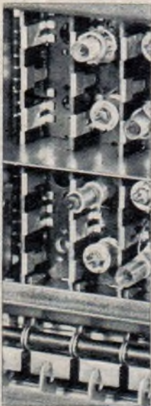
Schaltung a: Niederfrequenzteil des SH 1115 mit den klangbestimmenden Schaltmitteln
