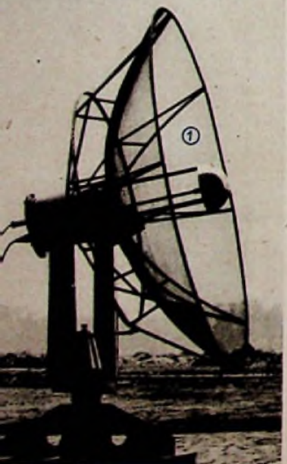
Abb. 3. Drehgestell mit Empfänger; ① Empfänger- spiegel 2,5 m mit eingebautem Dezi-Empfänger
