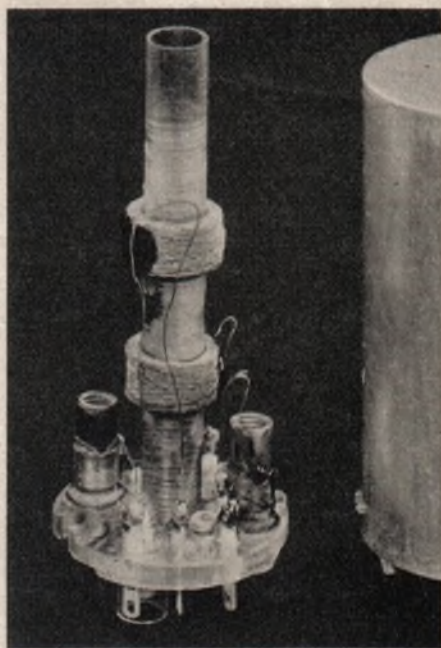
Abb. 2. Kombiniertes Bandfilter für AM und FM im Telefonken-„Andante“
