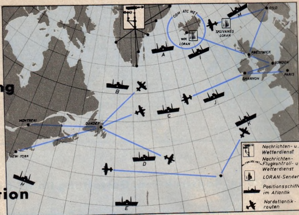
Abb. 1. Über den Atlantischen Ozean werden die Flugzeuge durch Navigationsschiffe mit Radaranlagen und Funkbaken sowie ferner durch LORAN-Longstreckennavigationsanlagen geleitet; Wetterstationen sorgen für regelmäßige Wettermeldungen
