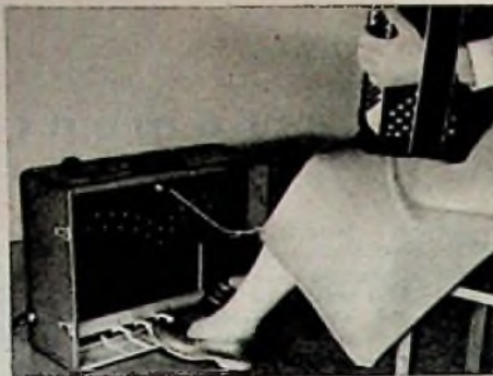
Oszillatorkoffer mit Schalleinrichtung der Hohner „Vox“, einer Kombination eines normalen Akkordeons mit einem monophonen Hohner-„Electronium“
