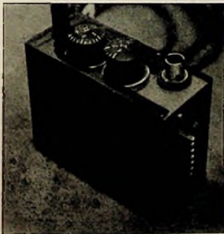
Abb. 3. Ansicht des Miniatursenders. Oben: Bedienungsknöpfe für die Abstimtrimmer C_6 und C_7 ; davor die abgeschirmte Eingangsbuchse B_1 . Vorn an der Schmalseite sitzt die Brechkupplung
