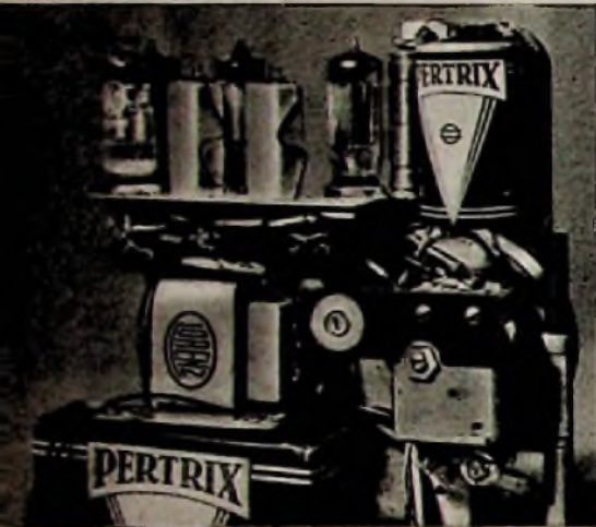
Teilansicht des Chassis. Links oben: Röhrenplatte mit Röhren und Bandfilter; neben der Monozelle sitzt der kleine gasdichte Deac-Stahlakku „450 D“
