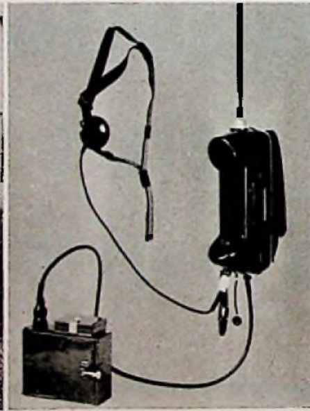
Links: UKW-FM-Funksprechergerät „FuG 250 K“ für Krafträder (Himmelwerk AG.) Rechts: UKW-Handfunksprecher „Kl 9“ mit Stromversorgungsteil (C. Lorenz AG.)
