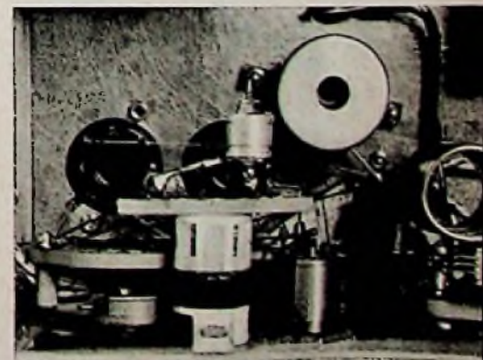
Abb. 6. Die erste Stufe mit Quarzschalter. Zwischen diesem und der Koaxbuchse Eingangskreis für VFO. Im Becher Katoden-, rechts Anodenkreis
