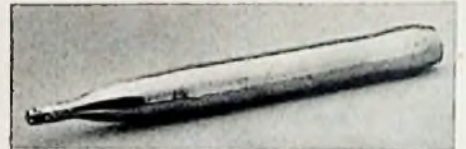
Gezüchteter Germanium- Einkristall (etwa 140 mm lang) als Ausgangsmate- rial für Gleichrichter und für Transistoren
