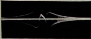
Abb. 4. Der Frequenz-Hub ist mit der Bandbreite des Oszillografenverstärkers vergleichbar
