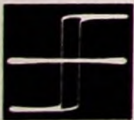
Abb. 3. Dielektrische Hysterese eines \text{BaTiO}_3 -Einkristalls unterhalb des Curie-Punktes 120^\circ \text{C}
