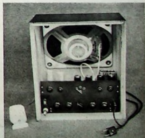
Abb. 3. Gesamtansicht des Gitarrenverstärkers. Auf der Frontplatte (v. l. n. r.) unten: Eingangsbuchsen, Höhenregler, Tiefenregler, Ein-Ausschalter, Gitarrenregler, Mikrofonregler. Obere Hälfte: Sicherungen (oben), Glühlampen und der Netzspannungswähler für 110, 125 und 220 V
