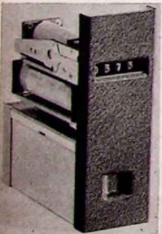
Abb. 1 Ansicht einer Zähldekade für 30 kHz mit der Valvo-Zählröhre E1T
