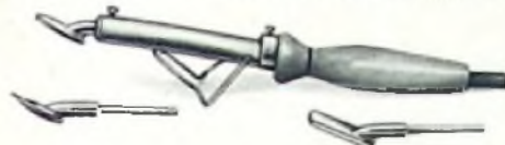
„Pico“-SpeziallötKolben mit verschiedenen Ein-sätzen; unten: „Löttring“-Schmelzeisen (W. Bittmann)
