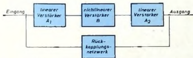
Abb. 2. Blocksdiagramm des Oszillators mit einem nichtlinearen Transistor in der zweiten Stufe
