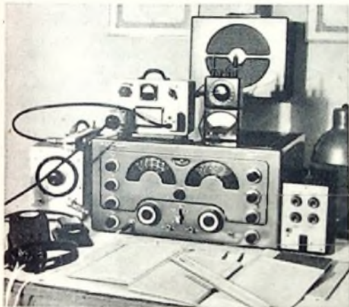
Abb. 9. Blick auf die Amateurstation DL3FM. Auf dem Doppelsuperhet „NC 183 D“ steht der Rauschgenerator, neben ihm ein Wechselspannungsgesetzgerät; links neben dem Superhet ein Konverter für das 435-MHz-Amateurband, darauf eine Rohkreis-HF-Vorstufe, an deren Eingang der Rauschgenerator angeschlossen ist. Rechts vom Superhet ist eine elektrische Taste angeordnet
