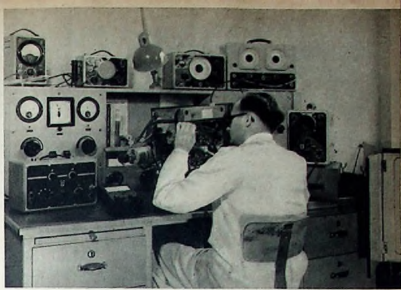
„Funke“-Oszillograf (Max Funke KG), daneben der Fernsehoszillograf Typ „6006“ (Grundig). Das rechte Foto zeigt einen ausschließlich mit Philips-Geräten ausgerüsteten, sehr praktischen Fernseh-Reparaturplatz
