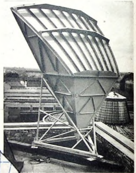
Schema der Abstrahlung einer Horn-Parabol-Antenne. Die elektrische Energie wird in einem scharfen Strahl in bestimmter Richtung gebündelt
