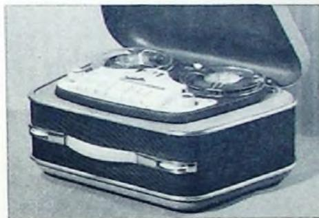
nale Spurlage, zwei Bandgeschwindigkeiten, vollautomatische Spurumschaltung, indirekter Bandantrieb mit Gleichlaufstabilisator, Aussteuerungsanzeige mit optischer Parallel-Lichtführung, eingebauter Mikrofonübertrager, Gerät als Mikrofon- und Phonoverstärker verwendbar (3,5-W-Endstufe), Regelorgane für Lautstärke und Tonblende auch bei geschlossenem Koffer von außen bedienbar, maximale Laufzeit drei Stunden, eingebauter Lautsprecher abschaltbar.
