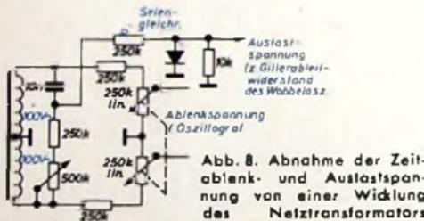
Abb. 8. Abnahme der Zeitablenk- und Austastspannung von einer Windung des Netztransformators
