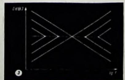
Abb. 3. Schematischer Frequenzgang der von H. Pfeiffer beschriebenen Fächerentzerrer
