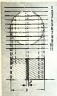
Darstellung der Impulsführung an einem vereinfachten Fernsehbild mit 11 Zeilen
