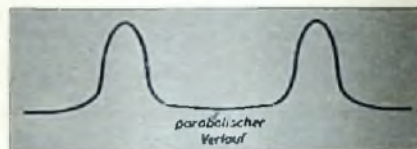
Bild 134. Spannungsverlauf für Tangenzverzerrung
