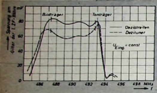
Bild 4. Durchlaßkurven zweier Deziteile (von Antenne bis zur 1. ZF-Röhre)
