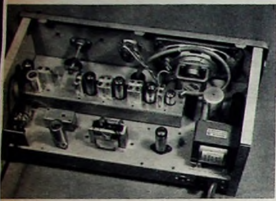
Unten: Chassiserückansicht des 2-m-Spitzensupers
