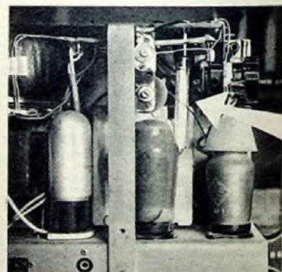
Bild 2. Amplituden-Glimmröhre zur Schmalband-Frequenzmodulation in einem Amateursender
