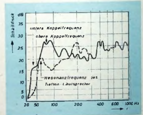
Bild 7. Verlauf des Schalldruckes im unteren Frequenzbereich (— — Lautsprecherkombination mit Baßreflexgehäuse; - - - - Lautsprecherkombination ohne Baßreflexgehäuse); Koppelresonanzen s. Pfeile
