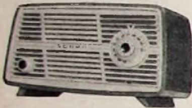
„Bobby“, ein 6-Kreiser mit gedruckter Schaltung (RFT, VEB Stern-Radio Sonneberg)
