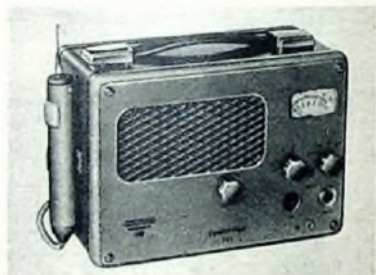
Prinzipschaltung und Ansicht des Signalverfolgers „SV 1“ von Grundig Electronic
