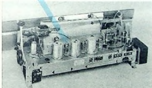
Bild 3a. Chassisbestückung des Empfängers „Wellsuper“
