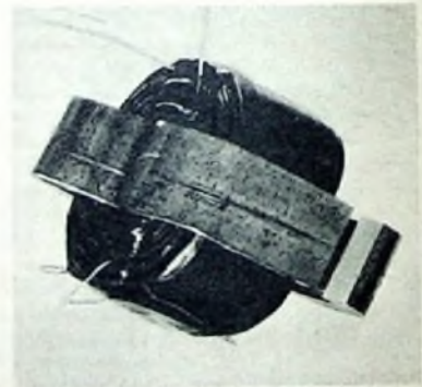
Bild 4. Spulenkörper mit aufgeschnittenem Schnittbandkern
