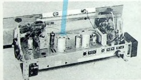
Bild 1 a. Chassisbestückung des Empfängers „Rialto“
