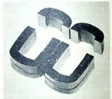
Bild 3. Der aus Texturblech gewickelte Eisenkern nach der Trennung
