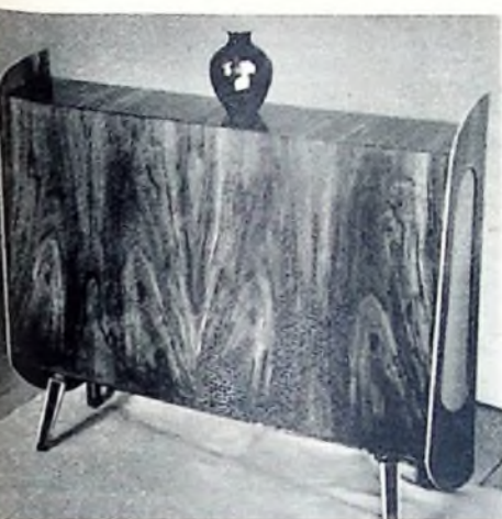
Bild 6. Ansicht der Baßreflexbox mit seitlichen Lautsprechern
