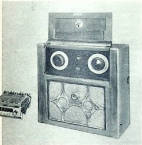
Blaupunkt-Kofferradio „TS 5“ mit Mittelwelle (Baujahr 1932) im Vergleich zum Blaupunkt-Autoempfänger „Frankfurt“ mit Mittel-, Lang- und Ultrakurzwellen
