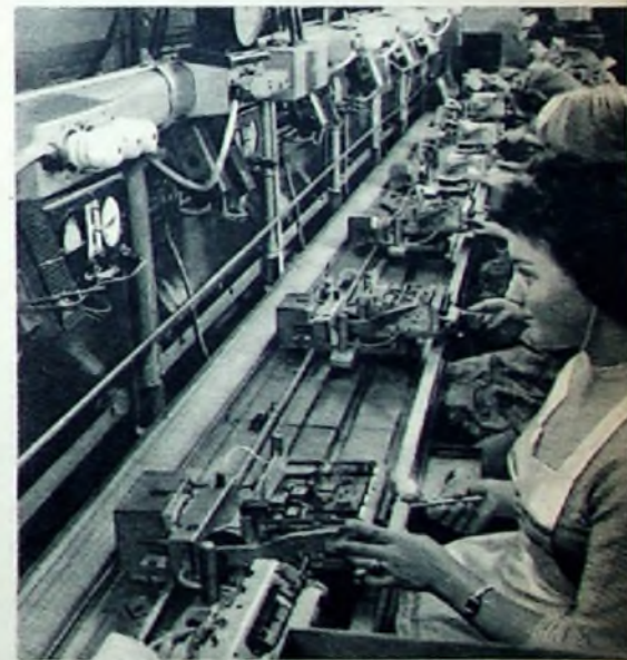
Auch im Abgleichprüffeld werden modernste Arbeitsmethoden benutzt, um durch Mechanisierung der Arbeitsplätze eine hohe Gleichmäßigkeit der Autoempfänger und damit eine Erhöhung der Qualität und auch der Betriebssicherheit zu erreichen
