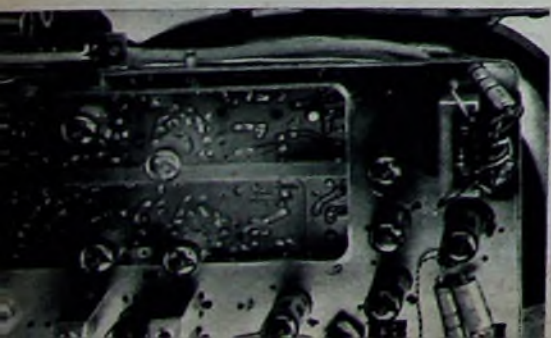
Bild 2 (oben). Gedruckte Platine mit Bild-ZF- und AM-Ton-ZF-Verstärker. Bild 3 (unten). Anordnung des Bild-ZF- und des AM-Ton-ZF-Verstärkers im Chassis
