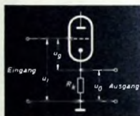
Bild 1. Grundsaltung des Katodenfolgers
