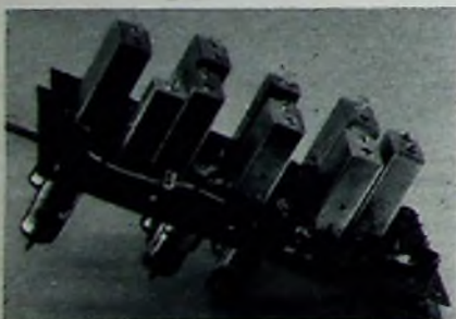
Bild 2 (oben). Gedruckte Platine mit Bild-ZF- und AM-Ton-ZF-Verstärker. Bild 3 (unten). Anordnung des Bild-ZF- und des AM-Ton-ZF-Verstärkers im Chassis
