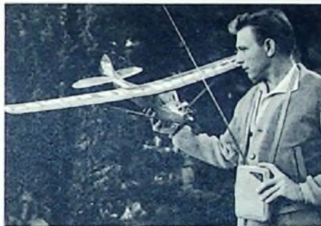
Bild 2. Der umgehängte Sender läßt sich mit der linken Hand bequem bedienen, so daß die rechte Hand des Operateurs frei für den Start des Flugmodells ist
