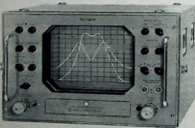
Bild 8. Abstimmeeffekte durch Kopplung von Dipol und Stub (7 m langer Dipol; Spule 7 Wdg., 4 cm \varnothing , 4 cm lang; 1,85 m langer Stub aus 300-Ohm-Bandleitung)
