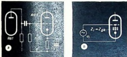
Bild 5. a) Verstärker in Katodenbasisschaltung; b) die Eingangsimpedanz ist beim Verstärker in Katodenbasisschaltung gleich der Impedanz zwischen Gitter und Katode
