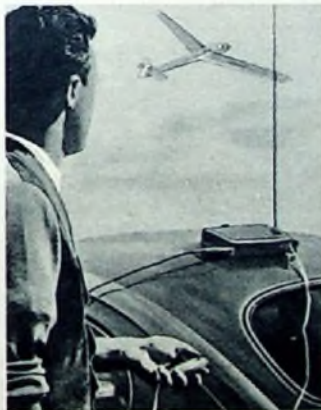
Bild 3. Auch als Standsender auf dem Autodach läßt sich der Sender betreiben, denn die eingebaute Antenne kann bis zu 90° abgewinkelt werden
