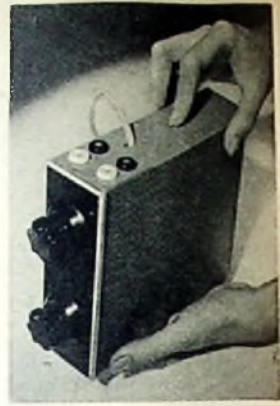
Bild 6. Ansicht des Mustergerätes; um die Eingangsbuchsen und das Fuß-Ausgangskabel zu zeigen, wurde die untere Schmalseite nach oben gedreht
