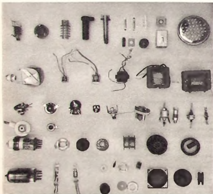
Bild 20. Ansicht verschiedener Miniatur-Einzelteile für Fernsteuerungsempfänger
