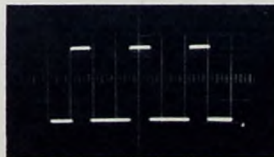
Bild 3. Oszillogramm des Horizontal-Balken-Generators nach Bild 2
