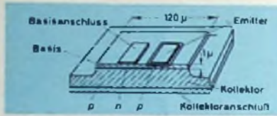
Bild 7. Aufbau eines Mesa-Transistors (Siemens)
