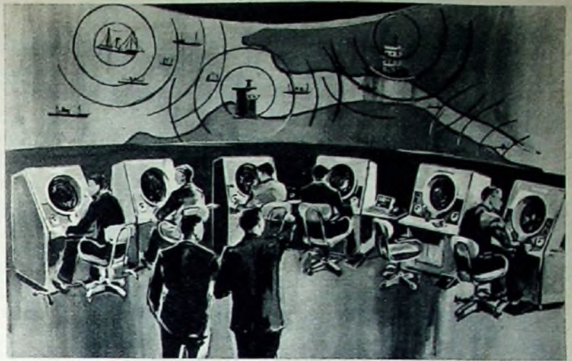
Zeichnerische Darstellung des Raumes für die Radarbeobachter in der Sicherungs-Radarstation Cuxhaven. Auf den fünf Bildschirmen wird das Fahrwasser in einer Länge von 50 km dargestellt. Die Karte an der Wand der Radar-Zentrale zeigt den insgesamt mit Philips-Radargeräten erfaßten Bereich des Elbe-Radar-Leitweges bis in den Hamburger Hafen
