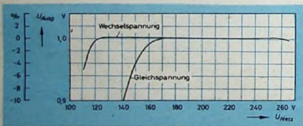
Bild 4. Verlauf der Ausgangsspannung der Brückenschaltung
