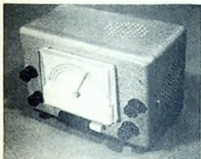
Ansicht des transistorisierten Zweikreisempfängers für Lautsprecherempfang (die Lautsprecheröffnungen liegen oben und seitlich im Empfängergehäuse)
