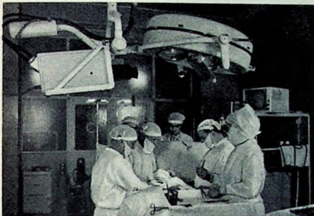
Bild 1. Die Farbfernsehkamera ist an der Operationsleuchte befestigt. Man erkennt in der Mitte der Leuchte den Umlenkspiegel und im Hintergrund rechts den 36-cm-Schwarzweiß-Monitor
