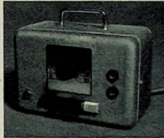
Bild 2. Ansicht des Gittervorspannungsgerätes für Netzbetrieb
