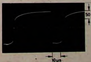
Bild 22. Steuerimpuls an der Pentodenanode
