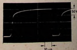
Bild 18. Steuerimpuls an der Heptodenanode
