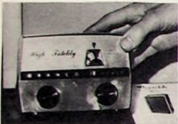
Ein mit nur drei Röhren bestückter FM-Tuner kleinster Abmessungen von Emerson, USA
