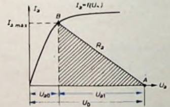
Bild 17 Leistungsdreieck bei einem Pentoden-Gegentakt-B-Verstärker
