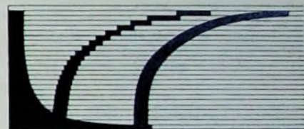
Bild 1. Schematische Darstellung des „Treppeneffekts“ im Fernsehbild; links: bisheriger Verlauf, rechts: mit „Sabavision“ glatter Verlauf
