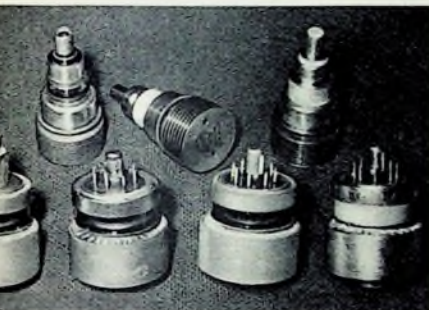
Bild 1. Koaxialröhren; obere Reihe von links nach rechts: 2C39A, 2x3CX100A5; untere Reihe von links nach rechts: 4X150G, 4X150A, 4X150D, 4X250B
