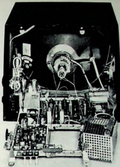
Klappchassis der Metz-Fernsehgeräte „Java“, „Capri“, „Samoa“ und „Hawaii“
