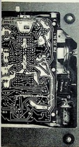
Oben: Tonbandgerät „RK 35“; links und unten: nach Lösen der Bodenplatte ist die gedruckte Schaltung sichtbar, die durch Herausklappen des Zugangs zum mechanischen Teil erleichtert
