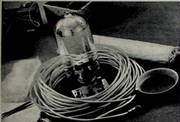
Bild 9. Zum Einbau des Steueroszillators in das Dewar-Gefäß (Isotherm-Dewar-Gefäß, Ausführung „A“, Nr. 12, Karlsruher Glas-technisches Werk, Karlsruhe-West, Gablonzer Straße 6) notwendiges Material (s. Text): Steueroszillator, Dewar-Gefäß, Kabel mit Steckern und Winkelstecker, Paraffin-Bienenwachs-Gemisch, Zellstoff, Watte und Pappe. Im Hintergrund der A-Verstärker und das Netzgerät
