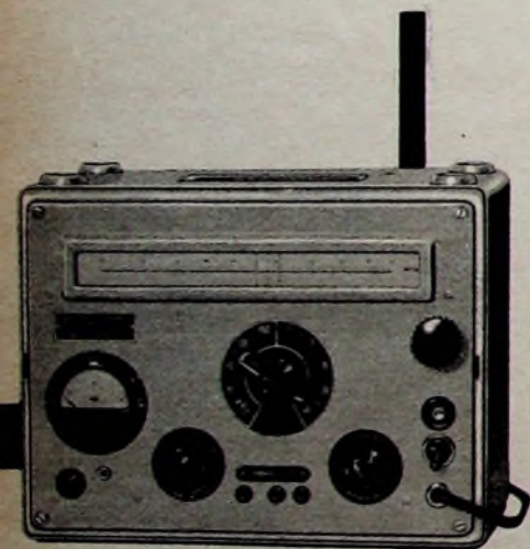
Einfacher Resonanz- Frequenzmesser WEN 10 kHz ... 30 MHz Fehlergrenzen: \pm 5\%
