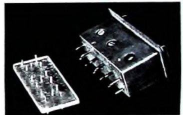
Bild 8. Kompletter HF-Spulenkasten (rechts) und gegossene, aber noch unbearbeitete Spulenplatte (links)
