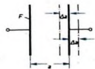
Bild 2. Prinzip des Meßkondensators mit Abstandsänderung
