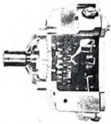
Bild 15. 40fach-Memomatic zur Speicherung der Feinabstimmung auf allen UHF-Kanälen (Philips)
