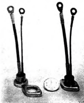
Bild 3. Rauscharme Transistoren SFT 237 und SFT 337 (Ditratherm)
