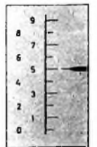
Bild 5. Anzeige mit Drehspulinstrument
