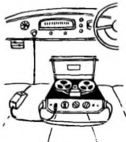
Verlängerte Lebensdauer der Batterien bei Betrieb mit Netzadapter
