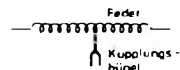
Bild 4. Schema für die Abnahme der verzögerten mechanischen Schwingung von der Verzögerungsfeder mittels einer Gabel, die auf das piezoelektrische Tonabnehmersystem wirkt
