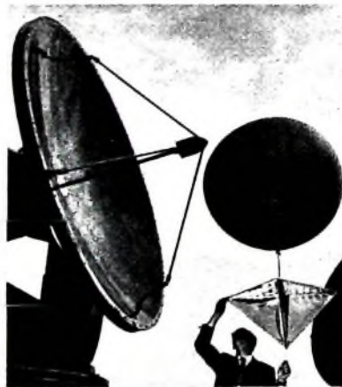
Wetterballon mit Reflektor und Parabolantenne der Cossor-Anlage „C.R. 353“
