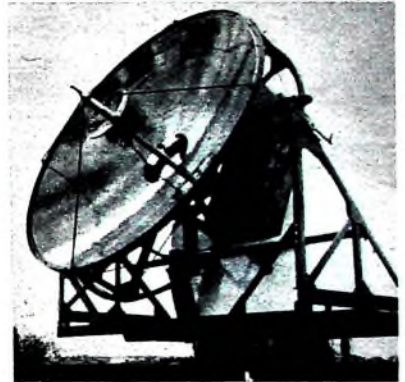
Der Hilfsspiegel der Antenne ist entlang der Antennenzufuhrspire herausgedreht; der HF-Teil befindet sich in dem Gehäuse hinter dem Hauptantennenspiegel
