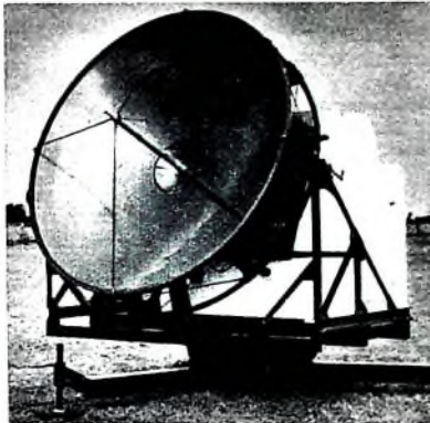
Höhenwindmeßradaranlage „WF 2“ mit Parabolspiegelantenne und Bedienungskabine (auf dem Kabinendach ist eine Klimaanlage montiert)
