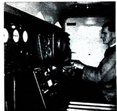
Blick in die Bedienungskabine der Höhenwindmeßradaranlage „WF 2“. Reichweitenanzeiger, Höhen- und Azimutanzeiger, Sichtgerät und Bedienungsgeschalt sind dem Bedienenden gegenüber; die Umdrehungen der Kabine und der Höhenwinkel der Antenne werden mit zwei Handrädern eingestellt
