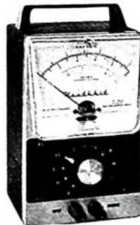
Technische Daten: Frequenzgang: ± 1 dB bei 10 Hz ... 500 kHz; ± 2 dB bei 10 Hz ... 1 MHz; Meßbereiche: 0 ... 10, 30, 100, 300 mV, 1, 3, 10, 30, 100, 300 V<sub>eff</sub>; Netzanschluß: 220 V / 50 Hz / 10 W; Maße: 190 x 120 x 115 mm; Gewicht: 1,7 kg
