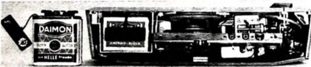
Bild 4. Nach Abnehmen der Bodenplatte läßt sich die Batterie bequem auswechseln. Nach Wahl können eine 9-V-Kompaktbatterie oder zwei 4,5-V-Flachbatterien (mit neuartigem Schnellklemmverschluss) eingesetzt werden
